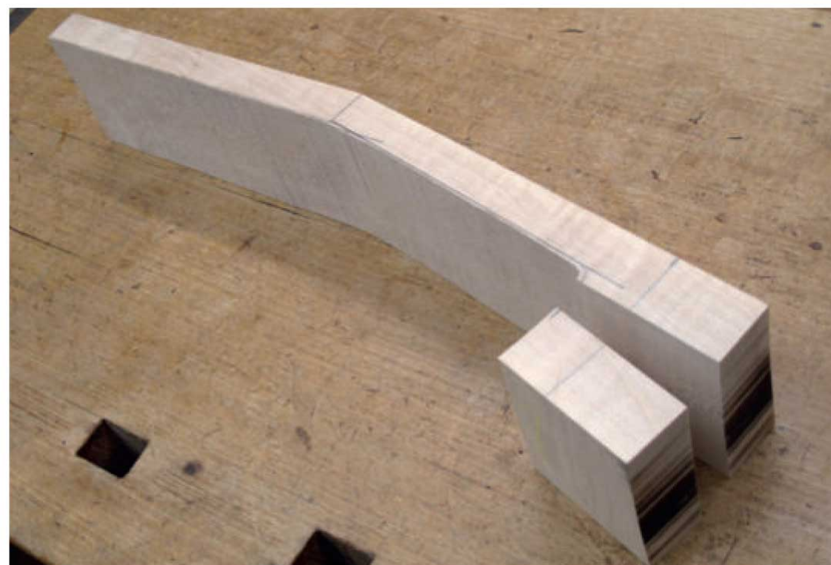
Abb. 10-4. Fertiger Rohling mit separiertem Halsfuß
