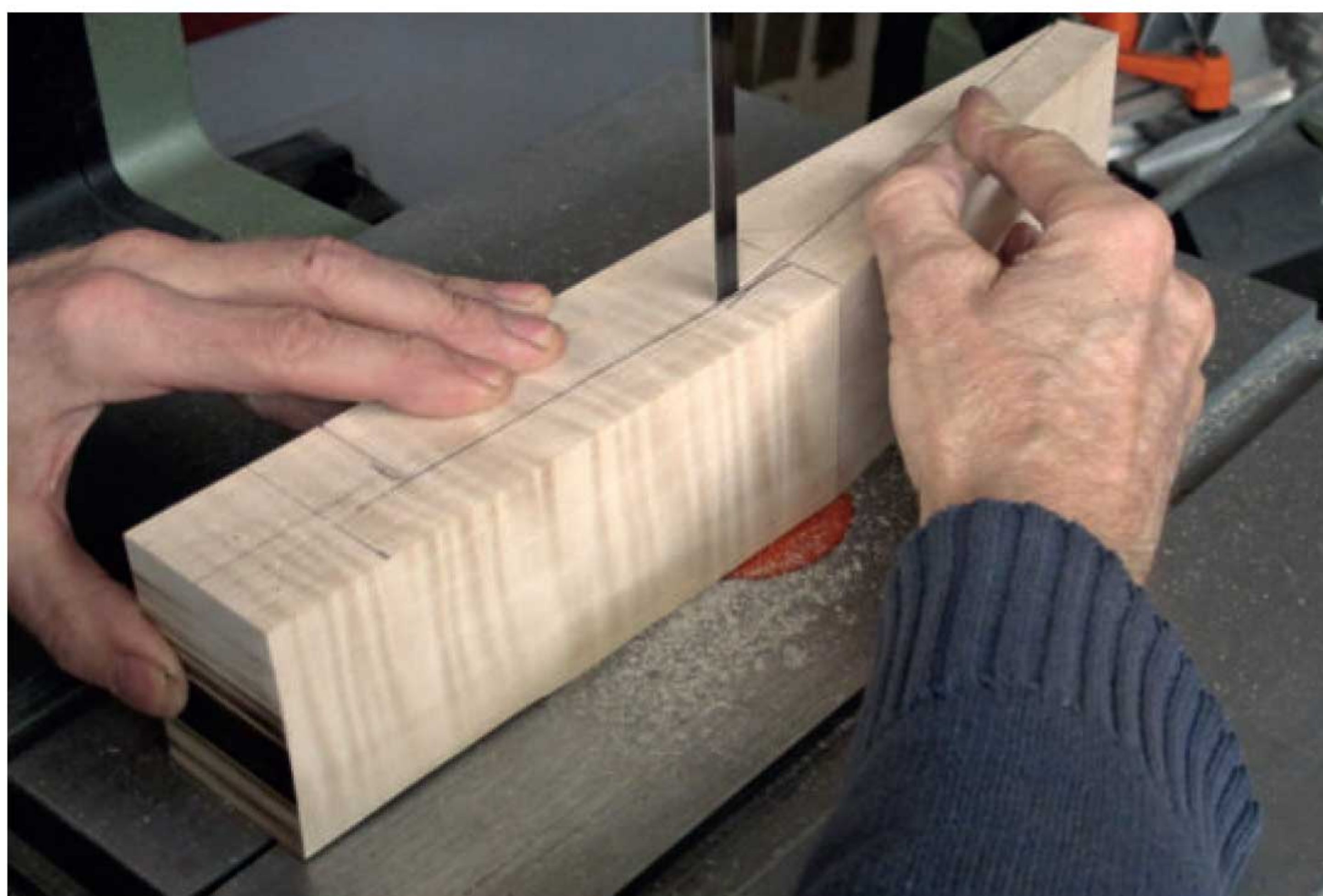
Abb. 10-3. Aussägen des Halsrohlings mit der Bandsäge
