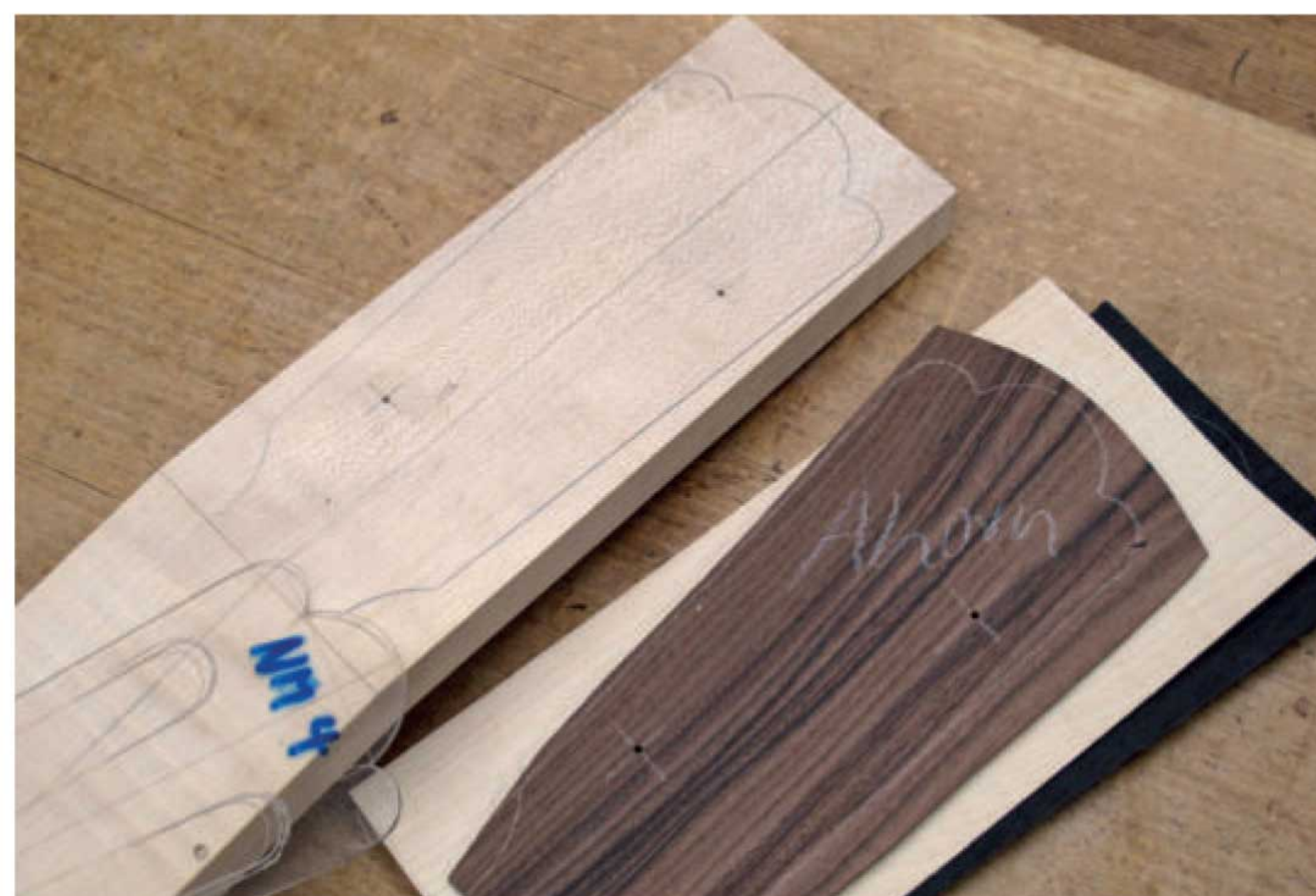
Abb. 10-6. Kopf und Furniere mit Positionierungsbohrungen
